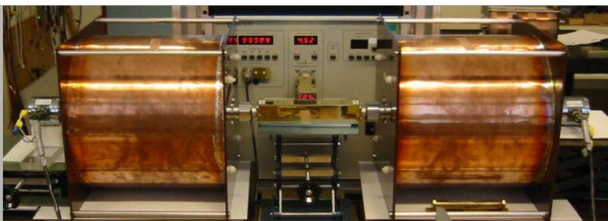
AC-DC Vergleich zweier Shunts bei 100 A
