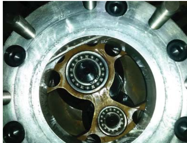
Abbildung 5: Innenansicht des Verdrängungszählers.
