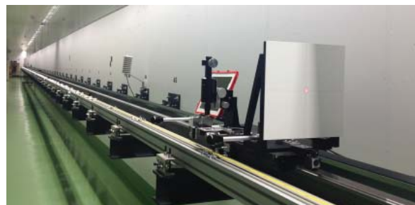
Abb. 1: Im BEV realisierte Messstrecke für elektro-optische Distanzmesser bis 50 m
