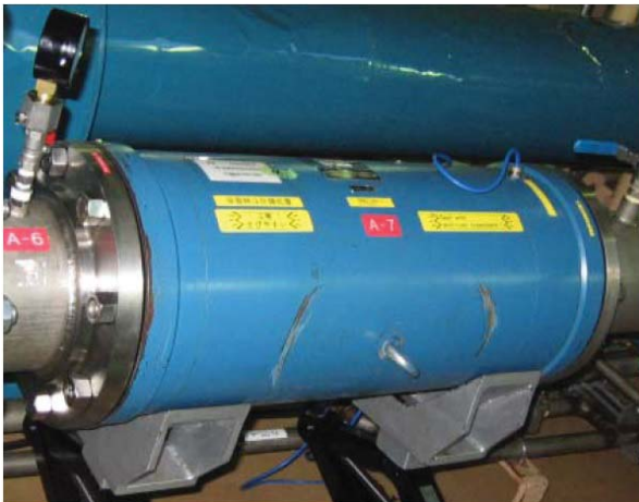
Abbildung 4: KRAL Zähler als Transfernormal.
