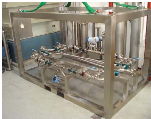
Abbildung 1: IKS SKID mit den Maßen Breite 1,3 m, Tiefe 2,5 m und Höhe 1,5 m
