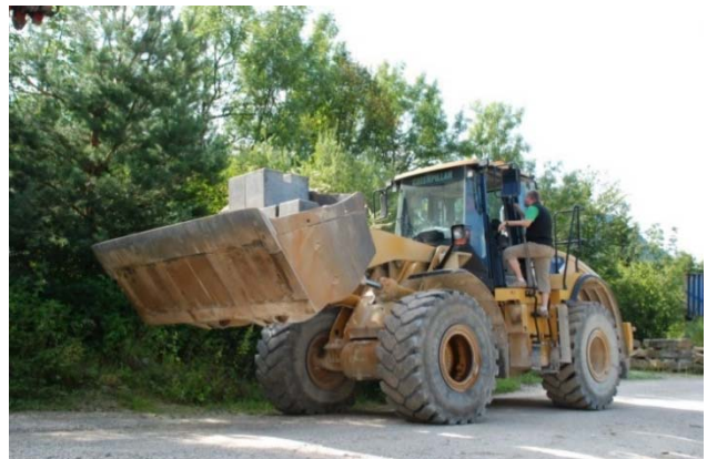
Abbildung 41: Schaufelladerwaage (Foto: Günther Thin / BEV)
