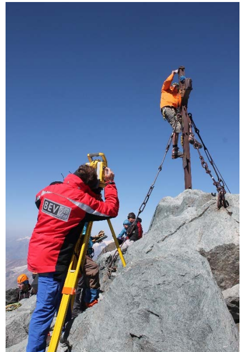
Abbildung 75: Vermessung des Gipfelkreuzes am Großglockner
