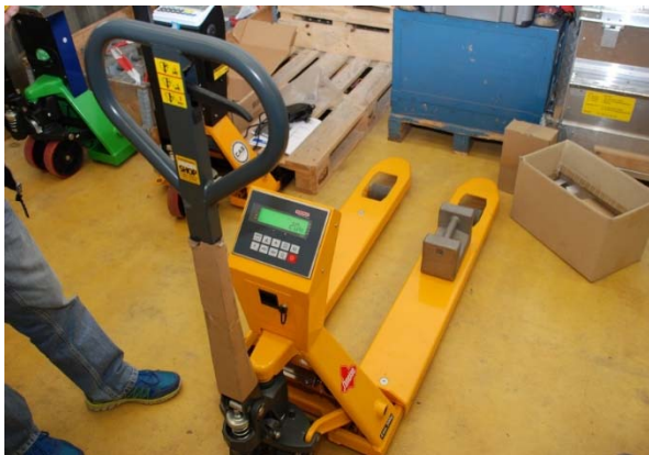
Abbildung 40: Handhubwagen mit Waage (Foto: Günther Thin / BEV)
