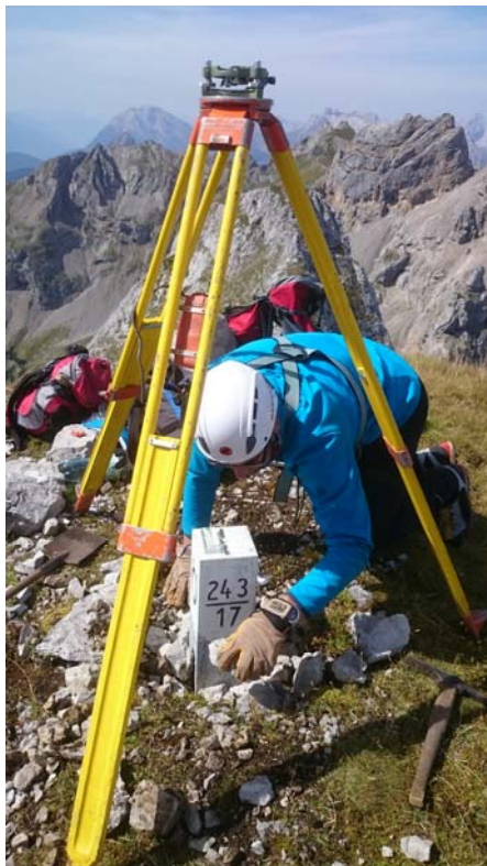
Abbildung 11: Vermessung eines Grenzsteins im Hochgebirge im Karwendelgebirge (Foto: Helmut Meissner)
