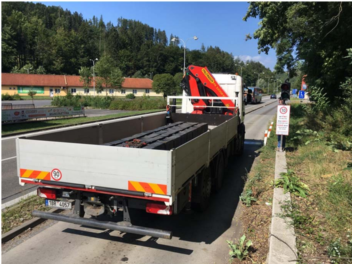
Abbildung 99: LKW während der Überfahrt - Kalibrierung einer Selbsttätigen Waage für das Wiegen von Fahrzeugen während der Überfahrt, an der tschechisch-slowakischen Grenze (September 2017).
