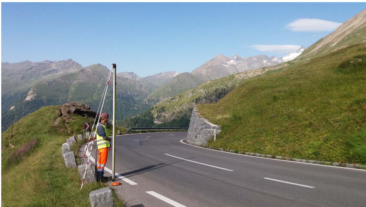
Abbildung 74: Messhelfer mit Präzisionsnivellementlatte an der Großglockner-Hochalpenstraße (Foto: Markus Bsteh / BEV)
